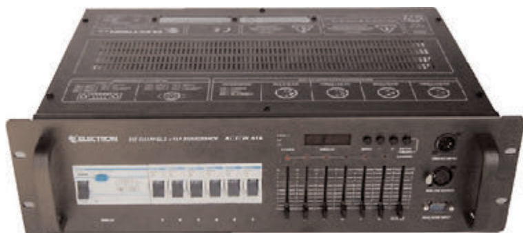
ACTOR 616 avec protections P+N et différentiel en entrée
