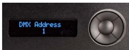
Configuration via écran OLED et clavier
